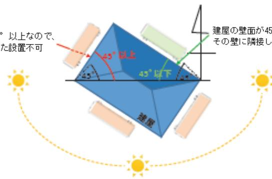
建屋の壁面が45°以下なので、その壁に隣接した設置可能
