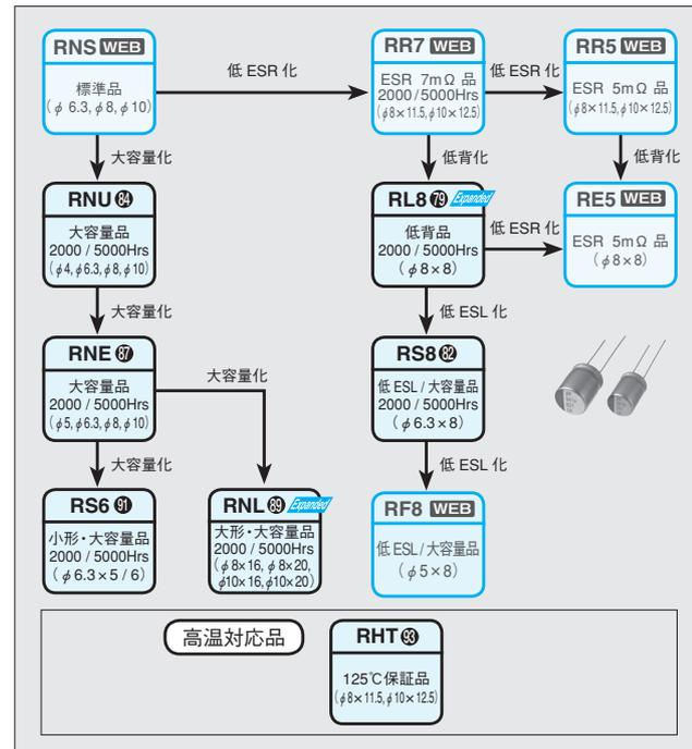
導電性高分子ハイブリッドアルミニウム電解コンデンサ体系図
