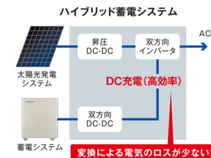
国内の幅広い太陽光発電システム、燃料電池とも接続可能!
