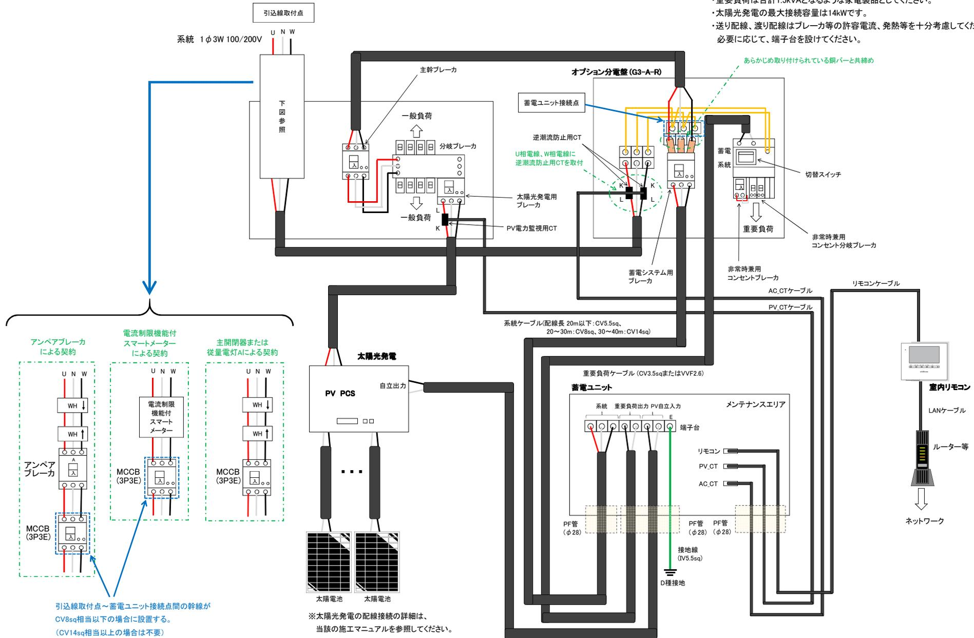
PV自立ケーブル(配線長 10m以下: CV3.5sqまたはVVF2.0、10～40m: CV5.5sqまたはVVF2.6)
