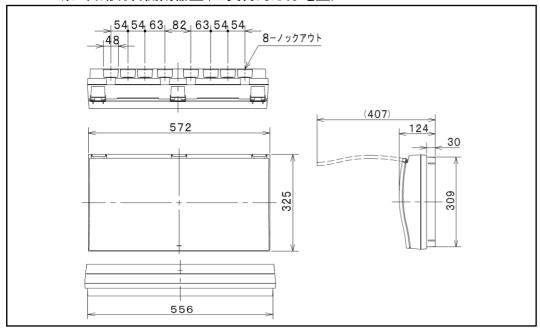
ESS-T1系 昇圧トランス: ESS-B5
