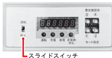
蓄電パワーコンディショナの操作パネル
