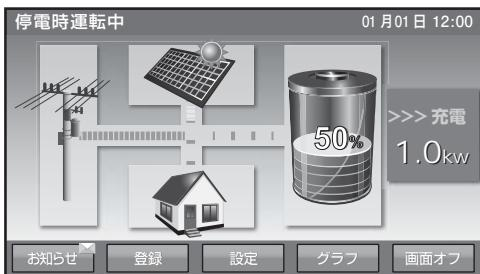
※ 停電時の動作中に太陽光パワーコンディショナに「EO」あるいは「STOP」などの点検コードを表示する場合があります。その場合は、太陽光パワーコンディショナの「取扱説明書」に従って、太陽光発電を再度、自立運転に切り替えてください。
