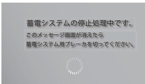
室内リモコンの画面が消えた後に蓄電システム用ブレーカを「OFF」にします。(分電盤内に「蓄電システム用ブレーカ」のシールが貼ってあります。)
