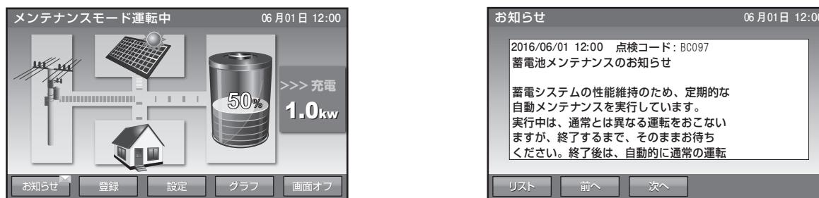
「充放電時間を設定する」（☞23ページ）で設定されている充電時間帯に充電を行い、その後、設定している通常運転モードで、時間帯に関係なく、蓄電池から放電を行います。メンテナンスモード終了後は、通常モードに戻ります。
