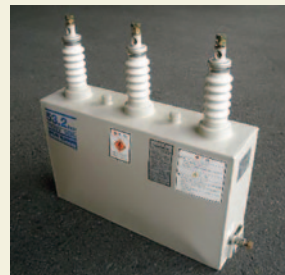
SH高圧進相コンデンサ(当社現行品)の保安装置作動後の外觀
