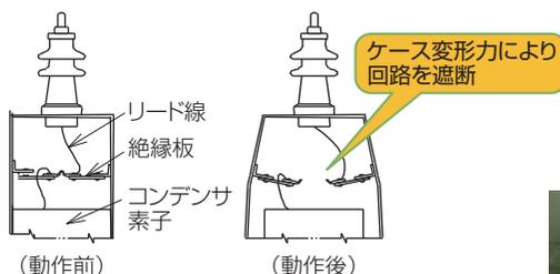
第1図 ニチコン油入式高圧進相コンデンサに採用されている保安装置
