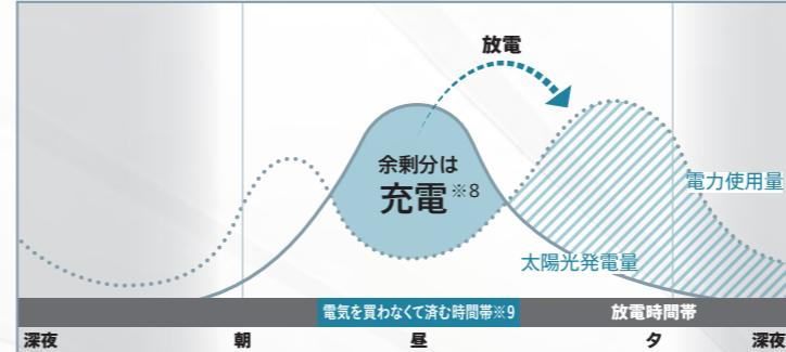
昼間、太陽光で発電した電気を蓄えて、夜間や朝夕の電力使用ピーク時に有効活用します。電気代の節約が可能。グリーンモードでも深夜電力を充電することができます。
