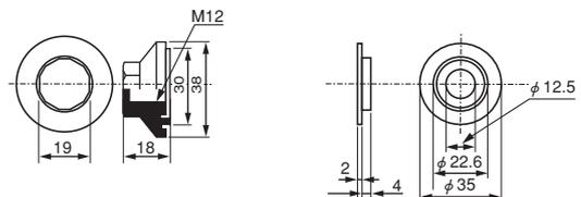
※取付孔径: φ 30.5mm (MIN.)
