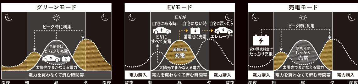
太陽光で発電した電力の余剰分を蓄電池と電気自動車に充電し自宅で使います。電力会社から電気をなるべく買わず、家産家消を目指します。
