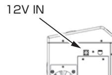
本体左側面の 12V IN に 12V 電源ケーブルを接続してください。
