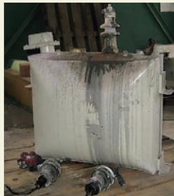
NH高圧進相コンデンサ (当社旧製品) の噴油・破壊 事故品
