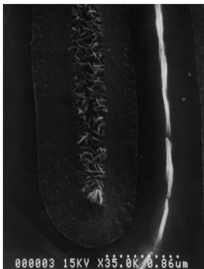
写真 1-4 中高压化成箔の断面写真
