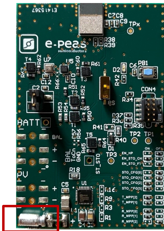
e-peas PMIC(パワーマネジメント IC) AEM10300 ニチコンの小形リチウムイオン二次電池 SLB シリーズが実装
